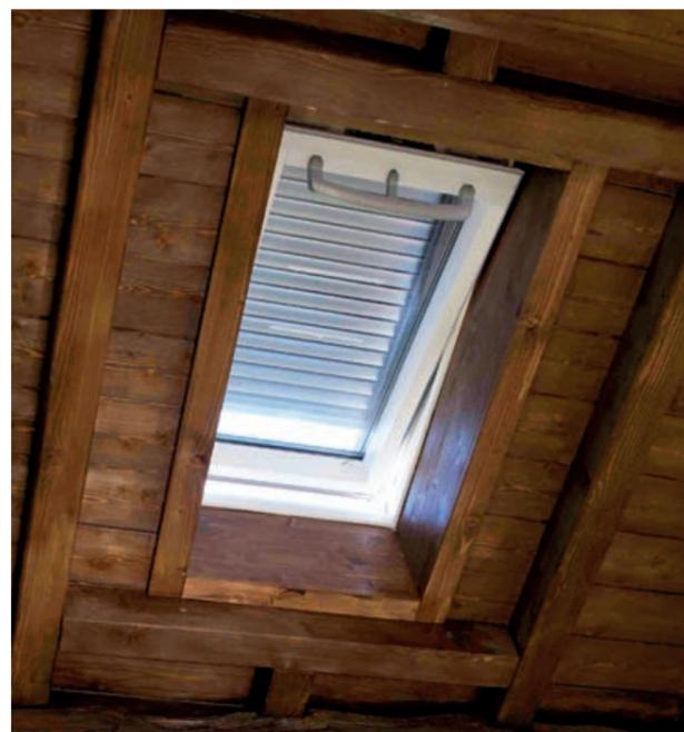
**Soluzione Roto utilizzata:** finestra RotoQ mod. Q4 con triplo vetro di sicurezza ad isolamento termoacustico, antiappannamento e antigrandine ( $U_w$  0,78), in legno naturale laccato bianco, equipaggiata di avvolgibile esterno elettrico per un maggior controllo dell'irraggiamento solare contro il surriscaldamento estivo.
