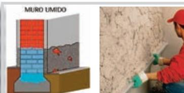
**DESCRIZIONE SOMMARIA DEL PRODOTTO:** l'intonaco risanante ISOTHERM è un prodotto professionale da applicare in caso di alto livello di umidità nelle murature interne ed esterne. Consumo: Per 1 Mq di intonaco steso a 2 cm. di spessore occorrono kg 25 di Isotherm, kg 6 di cemento 325, kg 5 di calce idraulica e 5-6 Lt. di acqua.
