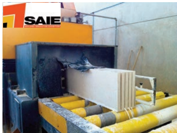
Fase di taglio del blocco intero di roccia ricostruita
