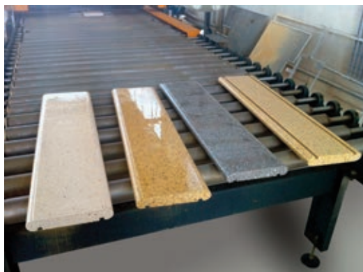
Levigatura e lucidatura, fase finale di produzione.
