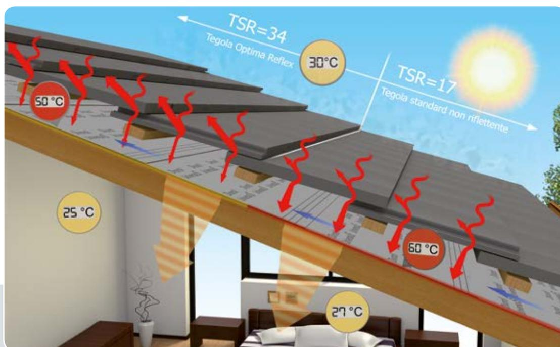
In condizioni normali, il manto di copertura si riscalda per effetto dell'irraggiamento solare raggiungendo temperature fino a 80°C.
