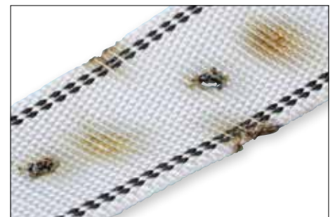
Forte sollecitazione termica, segni di bruciatura, schizzi di saldatura, ecc.
